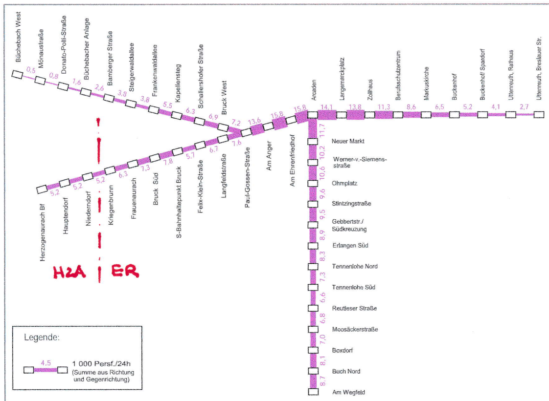
Abbildung 5-65 Teilstreckenbelastungen der StUB-Linien in der BI-Variante
